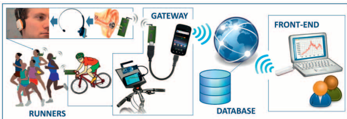
Funktionsweise des Systems. Kabellose Übermittlung der Körpertemperatur der Sportler in Echtzeit.
